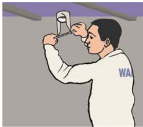
Figure 2 : Prélèvement d'une éprouvette par carottage
