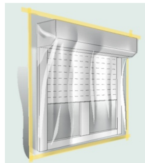
Figure 3 : Protection des ouvrants
