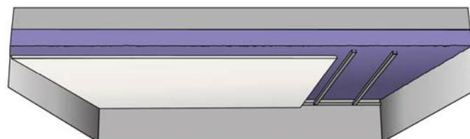
Figure 7 : Plafond suspendu constitué de montants simples ou doubles sans dispositif de suspension au support
