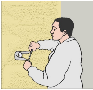
Figure n°2 : Prélèvement d'un échantillon sur chantier
