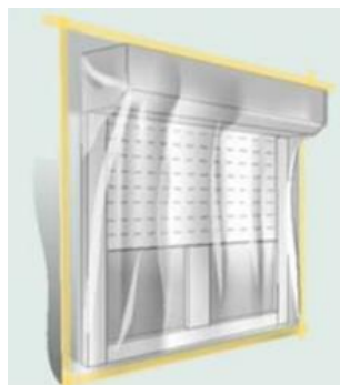
Figure 1 : Protection des éléments de construction
