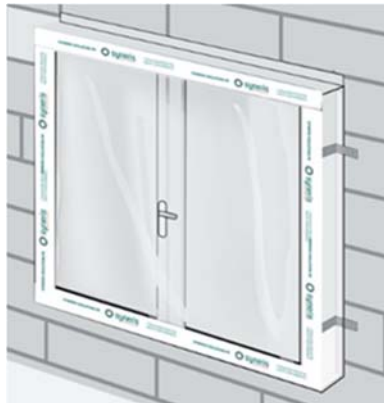
Figure 2 : Protection des éléments de construction
